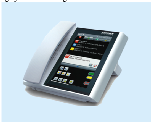
Terminal oddziałowy z panelem dotykowym ST Touch
